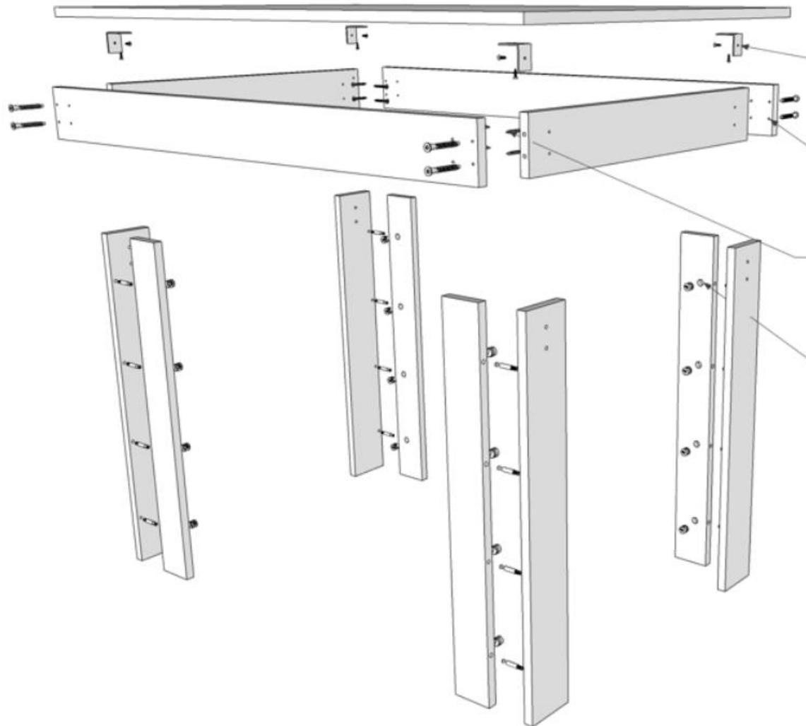
Breitwinkel dienen zur Befestigung der Platte an den Verbindungsteilen.
